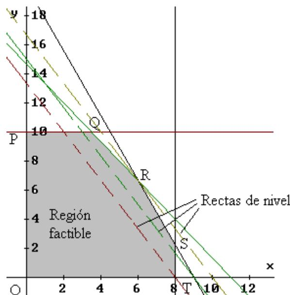
Trazando las rectas de nivel, de ecuación  $500x + 300y = k$ , y trasladándolas hacia la derecha –según el vector  $(500, 300)$ – se observa que el nivel máximo se obtiene en el vértice  $R = (6, 6,6666)$ .
